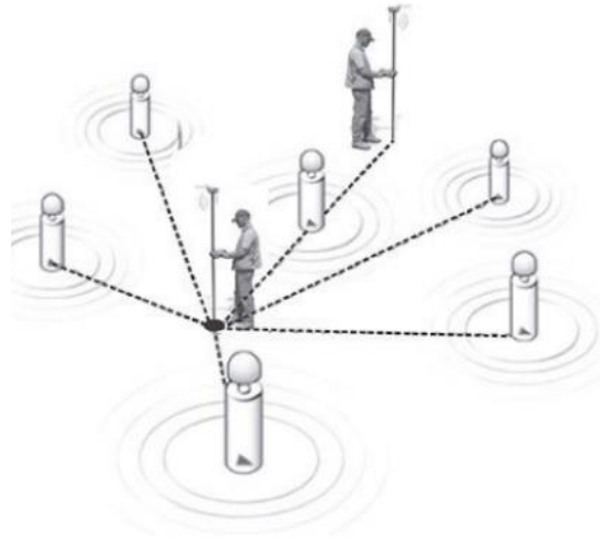
Exemplo de uso de uma rede de referência GNSS
